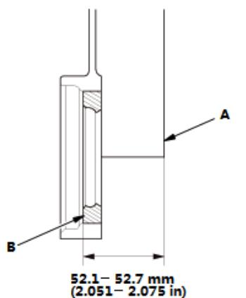
4. 测量凸轮链条箱表面 (A) 和油封 (B) 之间的距离。
